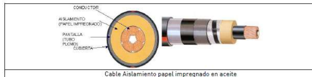
Cable Aislamiento papel impregnado en aceite
